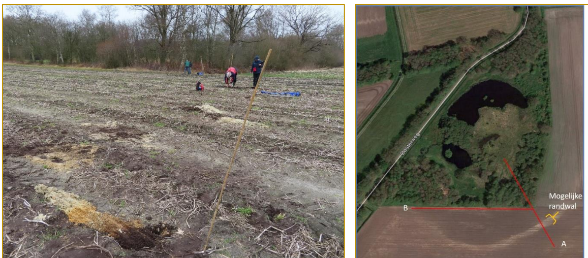
Figuur 10a. Uitgezette boorlocaties met behulp van tonkin stokjes en b. Raaien en mogelijke randwal.
